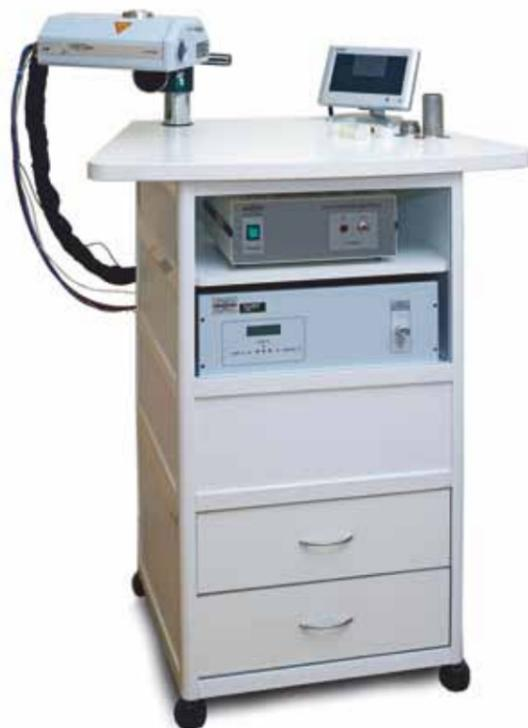
Рис. 1. Общий вид анализатора X-Арт М. На стойке сверху расположены: аналитический блок, который произвольно разворачивается в пространстве и передвигается вертикально на опоре с воздушным тормозом, и монитор с точным прицелом, указывающим область наблюдения. Ниже расположены: блок питания и управления системой возбуждения и спектрометрический тракт анализатора.
