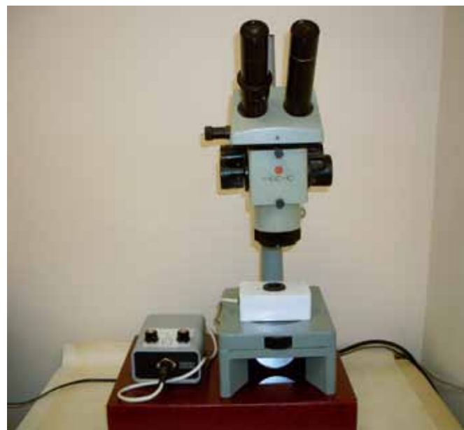
Илл. 1. Устройство для освещения документов. В центре корпуса выполнено конусообразное отверстие для наблюдения люминесценции, на которое устанавливается заградительный светофильтр. На блоке питания (слева) предусмотрена возможность попарного переключения светодиодов, излучающих свет длиной волны 470 нм, 520 нм и 585 нм, а также регулировки интенсивности светового излучения
