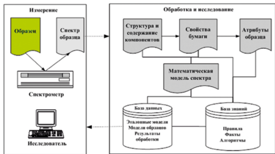
Рис. 11. Состав системы SpectralView
