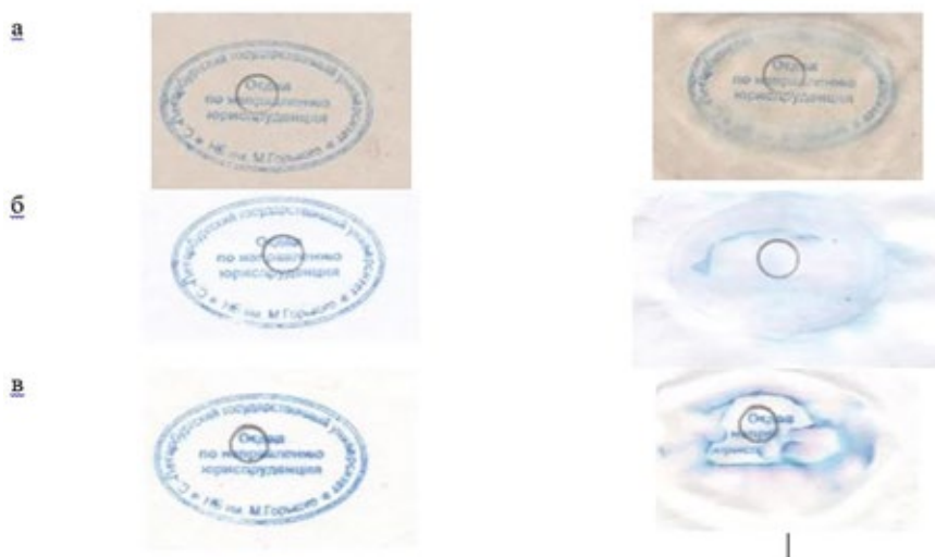
Ил. 3. Штемпельная краска CORIS (№ 3), нанесенная на бумагу, до (слева) и после (справа) нанесения циклодекана, водной обработки погружением и сушки: а — газетная бумага, б — офсетная бумага, в — бумага из 100 %-ной хлопковой целлюлозы
