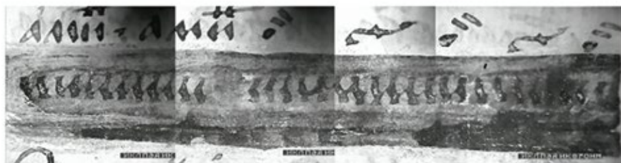
Ил. 1. Запись железогалловыми чернилами, закрасенная самим писцом (вверху), прочтение закрасенной записи в ближней ИК-области — комбинация снимков [20; 21]
