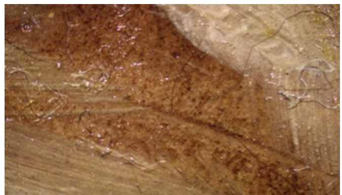
Ил. 3. Микрофотографии поверхности красочного слоя (в местах, не перекрытых красочным слоем, хорошо виден прозрачный желтоватый слой и бумажные волокна основы под ним); желтой стрелкой указано место отбора образца прозрачного слоя с темного участка для исследования методами рентгеноспектрального микроанализа и ИК-микроспектроскопии
