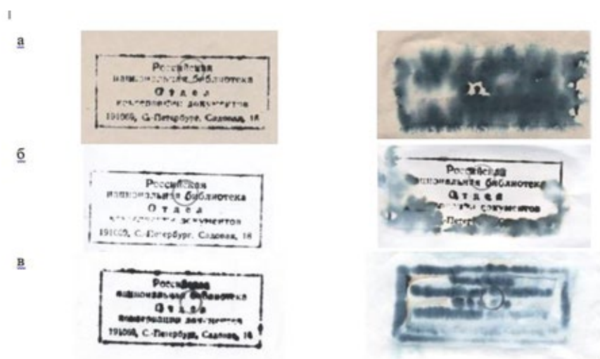
Ил. 2. Штемпельная краска «Гамма» (№ 2), нанесенная на бумагу, до (слева) и после (справа) нанесения циклодекана, водной обработки погружением и сушки: а — газетная бумага, б — офсетная бумага, в — бумага из 100 %-ной хлопковой целлюлозы
