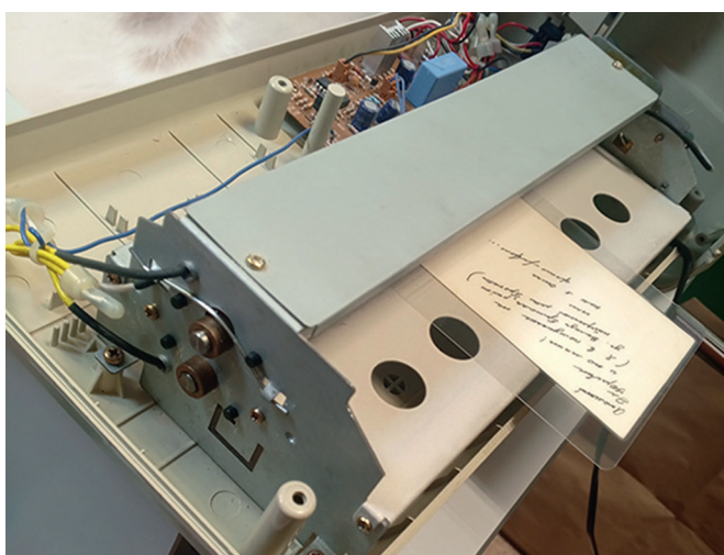
Ил. 5 б. Ламинатор, горячее ламинирование и ламинированная фотография. Санкт-Петербург. Октябрь 2025. © Из архива автора
